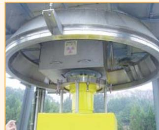
写真1:ガンマ線照射装置
